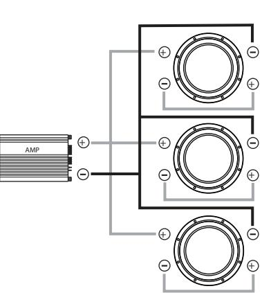
**With coils wired in series and speakers wired in parallel** (Con rollos alambró en la serie y oradores alambró en paralela, Avec les bobines télégraphiées dans le feuilleton et les haut-parleurs a télégraphié dans l'analogie, Mit Windungen, die in serie verdrahtet werden, und Sprecher haben parallel verdrahtet):
