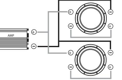
**With coils wired in series and speakers wired in parallel** (Con rollos y alambró en la serie y oradores alambró en la paralela, Avec les bobines télégraphiées dans le feuilleton et les haut-parleurs a analogie, Mit Windungen, die in serie verdrahtet werden, und Sprecher haben parallel verdrahtet):
