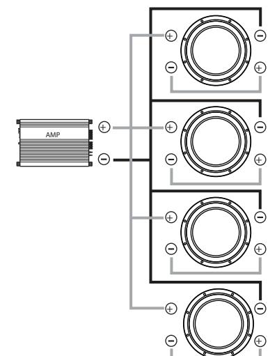
**With coils wired in series and speakers wired in parallel** (Con rollos alambró en la serie y oradores alambró en paralela, Avec les bobines télégraphiées dans le feuilleton et les haut-parleurs a télégraphie dans l'analogie, Mit Windungen die in serie verdrahtet werden, und Sprecher haben parallel verdrahtet):
