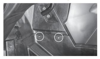
Step 2 - Remove the top 13mm body bolt.
